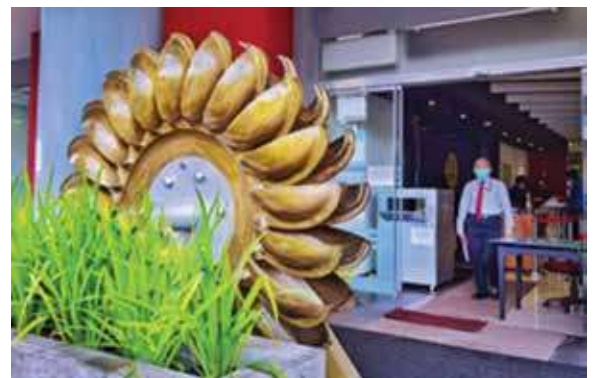
රූපය A 9: ලං.වි.ම. ප්‍රධාන කාර්යාලයේ සවිකර ඇති පෙල්ටින් ධාවකය
